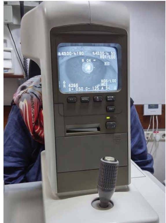
Şekil 7.2. Otomatik refkeratometre cihazı. Monitörde hem refraksiyon hem de keratometriye ait değerler görülmektedir.
